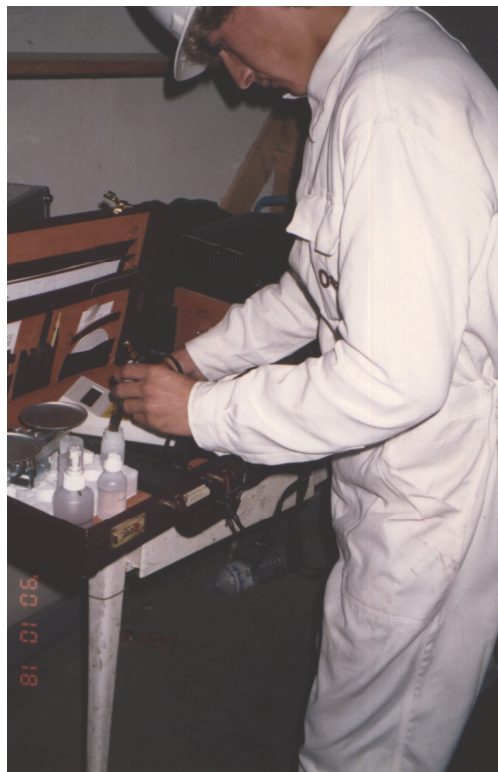
Fig. 2 - Equipamento para determinação in situ do teor de cloretos do betão.
